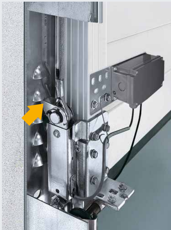
Zatrząsk rygłujący w kształcie haka blokuje się automatycznie przy próbie podważenia bramy.
