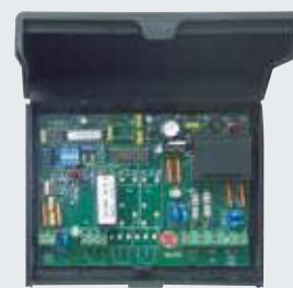
Obudowa dekodera Do sterowników kodowanych cyfrowo CTR 1b-1, CTR 3b-1, CTV 3-1, CTP 3.
