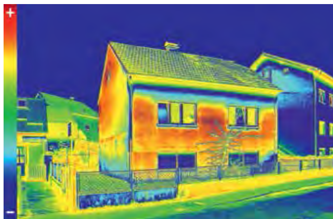
Zdjęcie termograficzne budynku mieszkalnego
